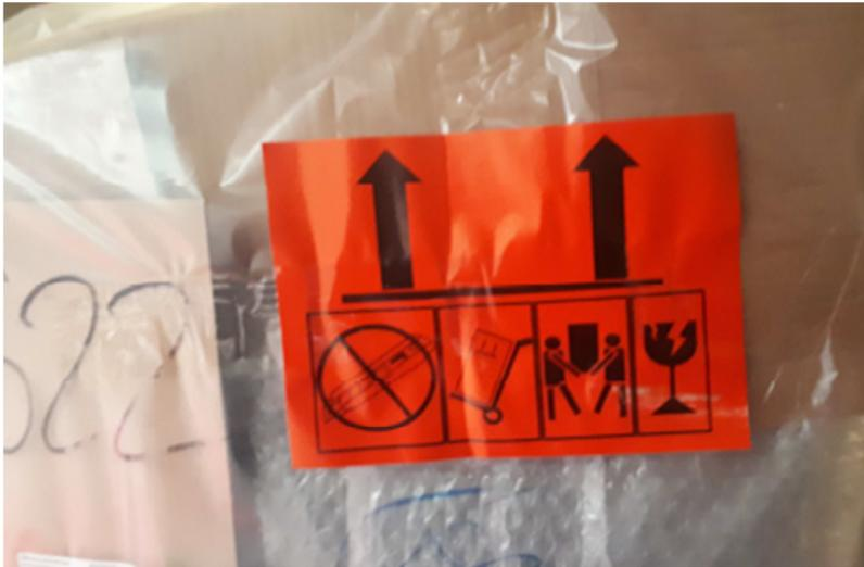
Es wird eine HDPE-Folie zusammen mit einer LDPE Luftpolsterfolie, farbigen Etiketten sowie PPK-Anteilen verwendet. Die PPK-Bestandteile sind teilweise mit der Folie verklebt. Hier gilt es, sich auf PPK und LDPE-Folie zu beschränken.
