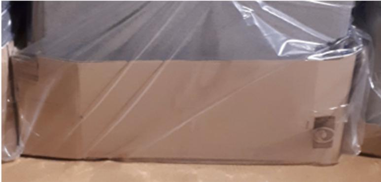
Dies ist ein vorbildlicher Kantenschutz aus PPK. Auf Schäume, Luftpolsterfolie etc. wird verzichtet. Zudem wird transparente LDPE-Folie mit wenig Etikettierung verwendet.
